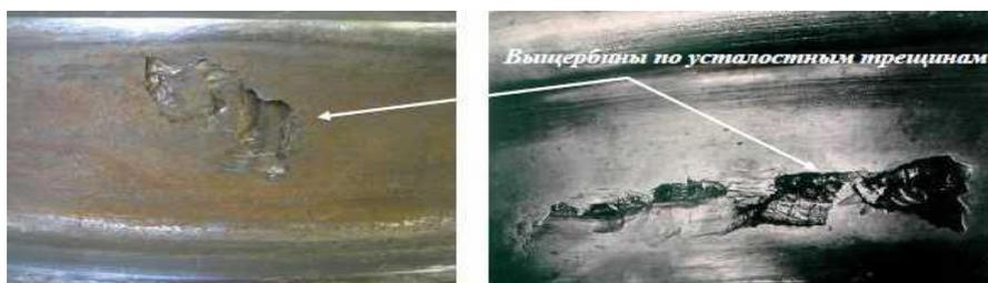
Рисунок 1.18 – Результат выщербины по месту образования усталостных трещин
