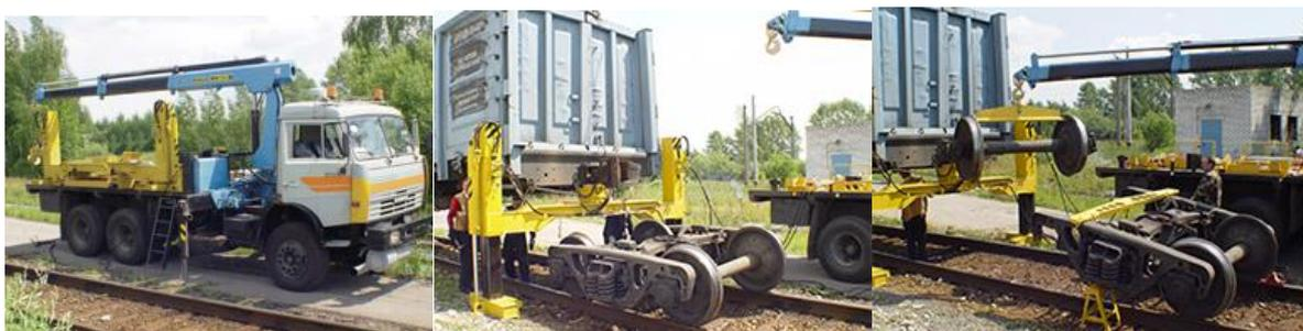
Рисунок 4.2 - Ремонтный железнодорожный комплекс РК-1М
