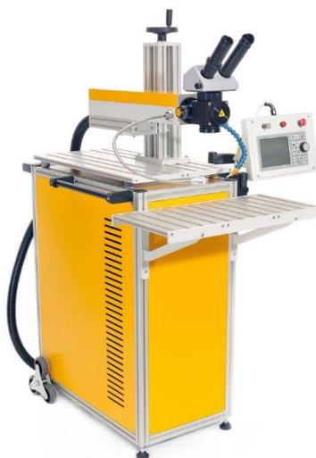
Рисунок 4.11 – Внешний вид установки лазерной наплавки МУЛ-1
