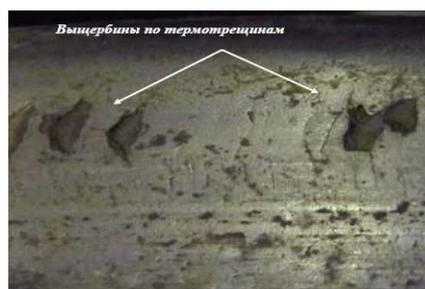
Рисунок 1.19 – Термотрещины в выщербине
