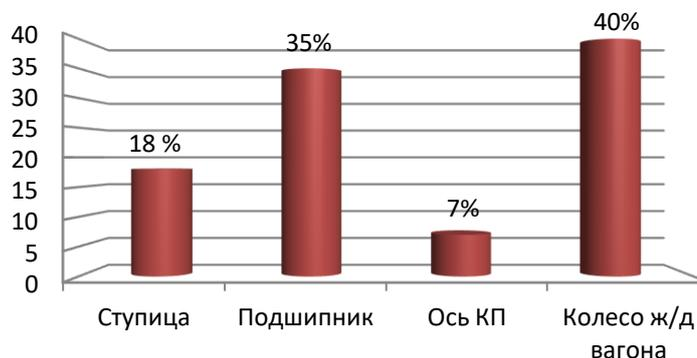
Рисунок 1.13 – Виды отказов по конструкциям колесных пар
