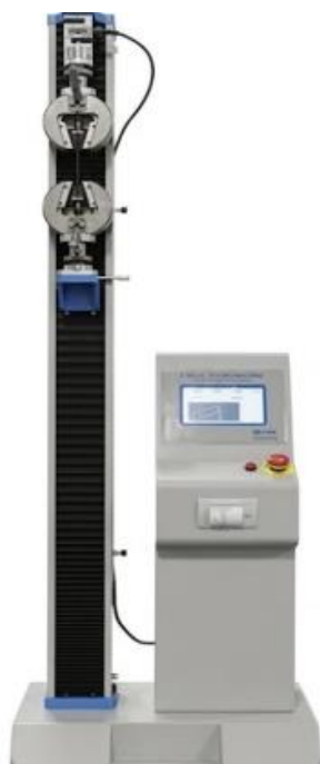
Рисунок 2 – Разрывная машина, марки HD-B617-S
