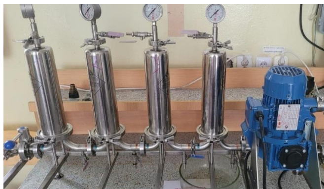
Рисунок 1 - Корпусная установка для фильтрации модель MR63B4
